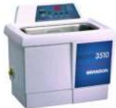
Ултрасоник ювиш- бу юқори частотали суюқлик, суюқликда тарқалади, ўз навбатида юқори ва паст босимли түлқинларни ҳосил қиласы.
