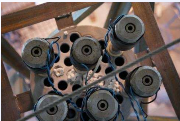
Засыпка катализатора и проведение испытаний
